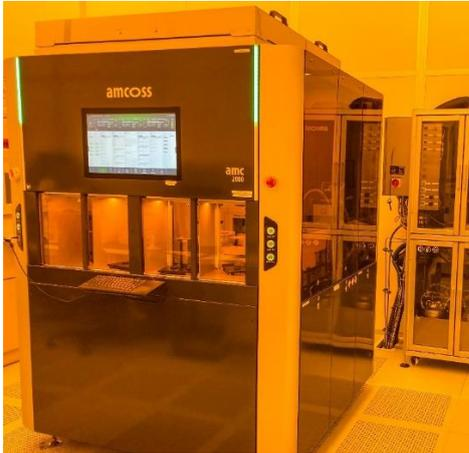
amcoss amc 2000 für die vollautomatische, gleichzeitige Belackung und Entwicklung von Wafern und Substraten mit unterschiedlichen Durchmessern.
